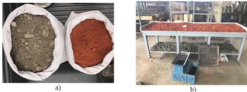
Figura 6-Amostragem; a) Amostras recolhidas; b) Secagem ao ar livre, esquartelador e malhas \frac{3}{4} e 4
