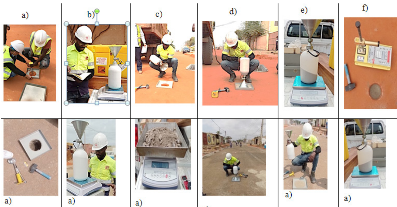
Figura 17- Ensaios de campo com Garrafa de areia da camada de solos; a) abertura do orifício, b) pesagem antes de a colocar no orifício, c) Colocação do funil na placa, d) queda da areia, e) pesagem depois de retira-la do orifício, e) determinação do teor em água. Ensaios de campo com a Garrafa de areia da camada de ToutVenant; a) abertura do orifício de ensaio, b) pesagem da garrafa antes de a colocar no orifício, c) pesagem do material húmido, d) preenchimento do orifício com areia, e) retirada da garrafa, e) pesagem depois da garrafa depois de retirá-la do orifício de ensaio.
