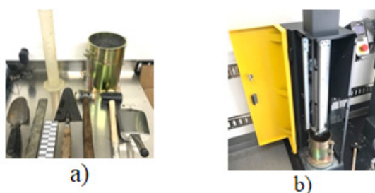
Figura 13- Compactação proctor; a) Utensílios de laboratório, b) Compactador dinâmico
